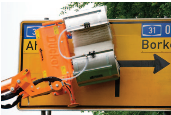
LPW 500 bei der Reinigung von Schildern
