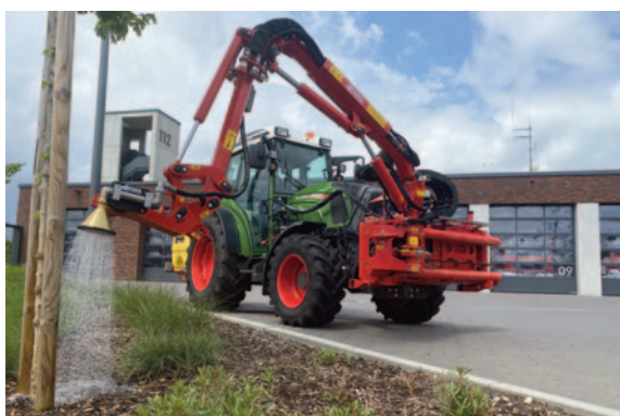
Gießkopf im Einsatz
