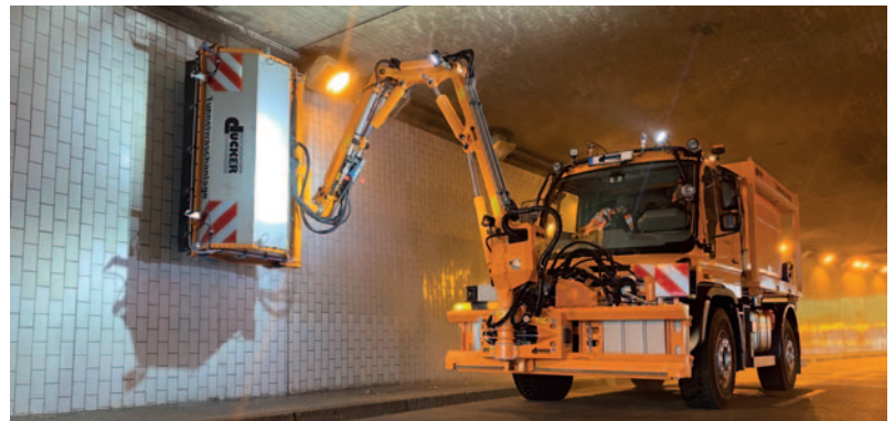
Einsatz TWA im Tunnel
