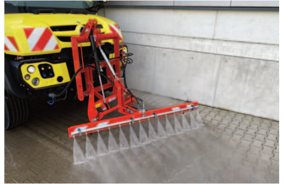
Hochdruckschwemmbalken montiert an die Anbauplatte
