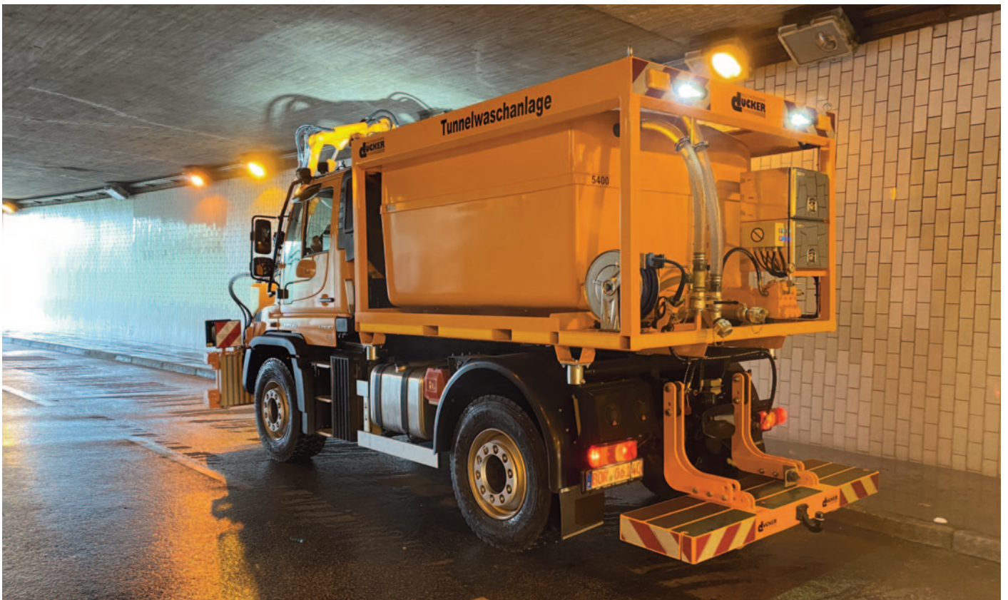
Würfelrahmen um den Wassertank
