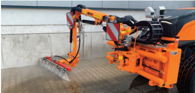
Hochdruckschwemmbalken montiert am Ausleger
