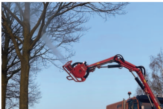
Gebläse mit Sprühvorrichtung im Einsatz
