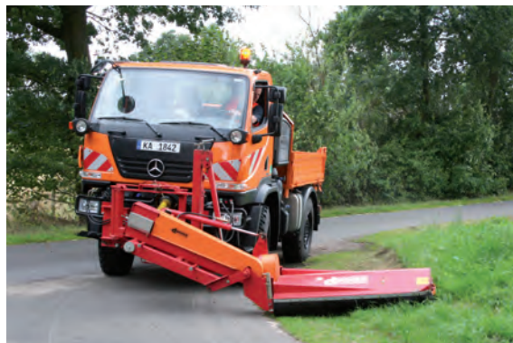
SMT 15 linksarbeitend am Unimog U20
