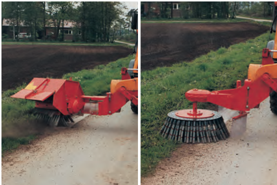
SMT 15 mit Radialwildkrautbürste und Pflasterputzer
