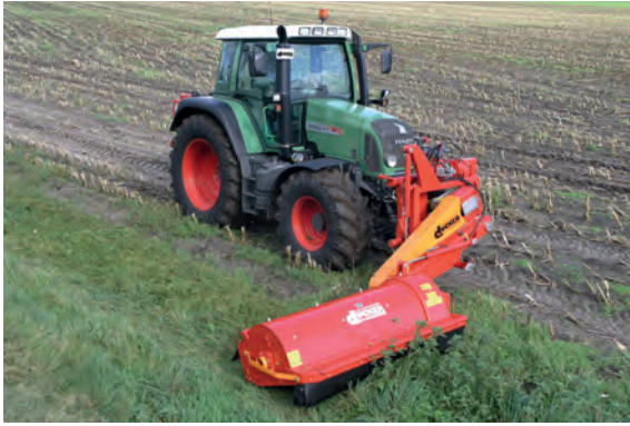
SMK 15 rechtsarbeitend am Schlepper
