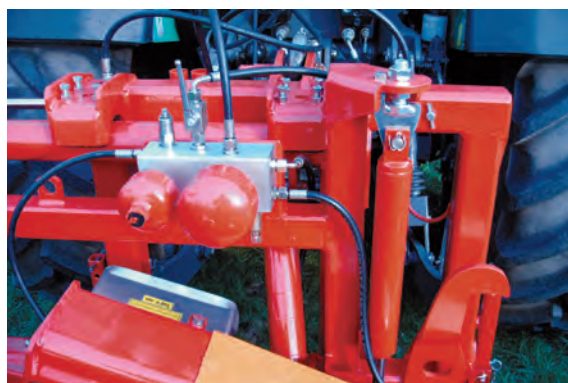
zentraler Hydraulikblock mit Stickstoffpuffer
