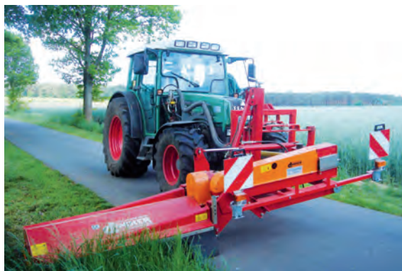
SMT 15 rechtsarbeitend am Schlepper
