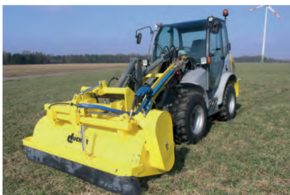
UMK 18 mit hydraulischem Antrieb, Anbau am Radlader
