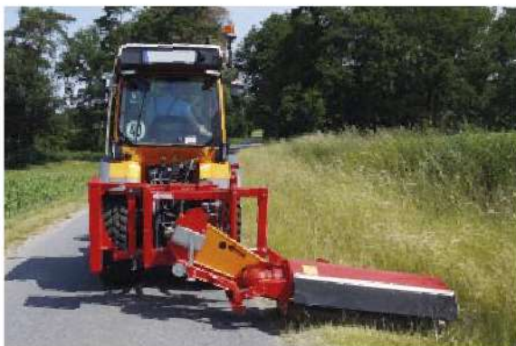
USM 13 beim Mähen von Grabenböschungen
