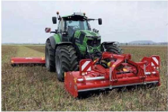
Schlegelmäher UMG 2800 in Kombination mit Schlegelseitenmäher USM
