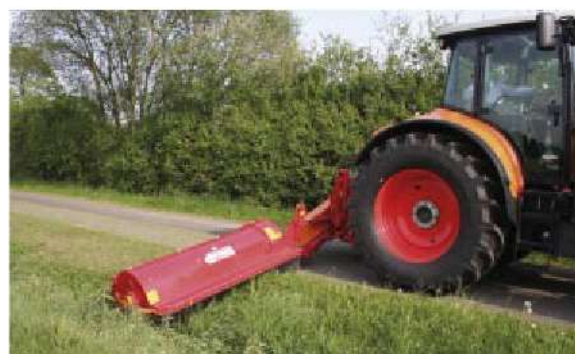
USM 18 beim Mähen von Grabenböschungen
