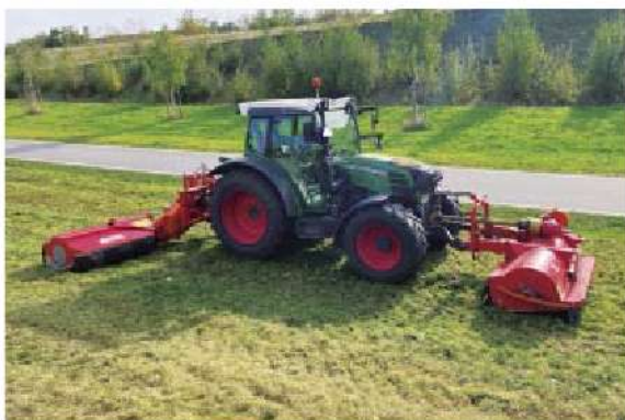
UMK 18 in Frontanbau mit UMS 1600 im Heckanbau
