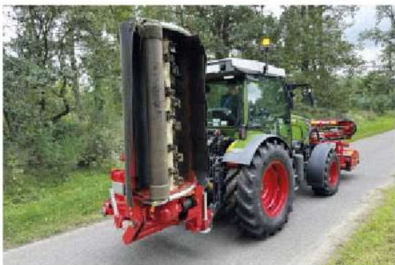
UMS mit 900er Schlegel in Transportstellung
