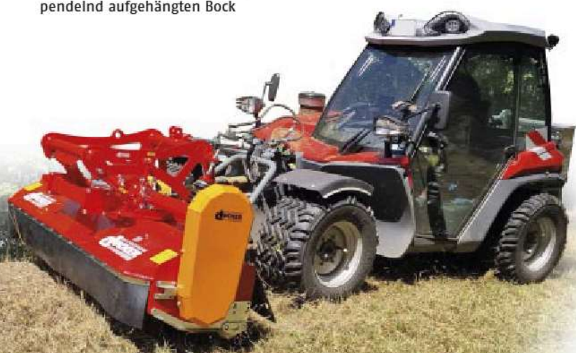
Schlegelmäher VMS 2200 in Frontanbau mit ziehend und pendelnd aufgehängten Bock
