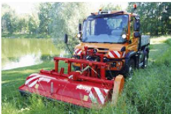
UM 27 im Frontanbau mit hydraulischer Verschiebung
