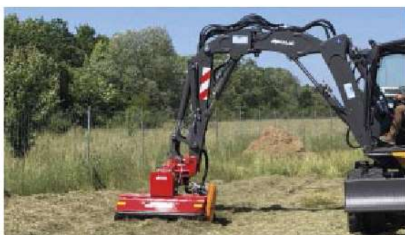
Schlegelmäher VMS am Bagger
