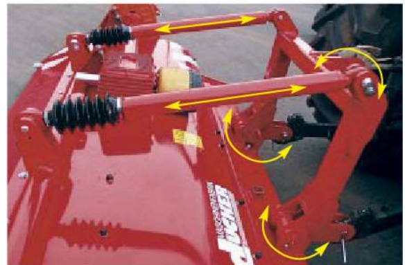
Anbaubock bei UM 27, 30 und 40 mit Gelenkpunkten und Abfederung nach hinten
