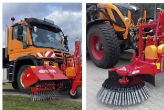
SMT 15 mit Radialwildkrautbürste und Pflasterputzer
