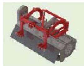
Bild 3) Frontanbau ziehend aufgehängt mit hydraulischer Verschiebung um 0,60 m
