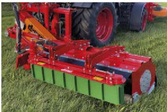
UMS mit Förderband zur seitlichen Ablage des Mähguts
