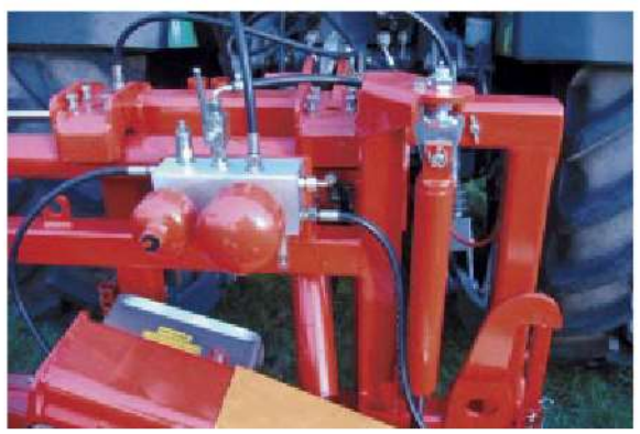
zentraler Hydraulikblock mit Stickstoffpuffer
