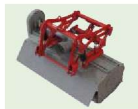
Bild 5) Frontanbau, ziehend und pendelnd aufgehängt
