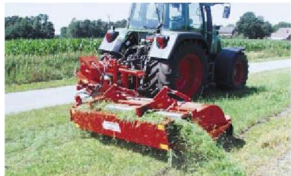
USM mit Förderband zur seitlichen Ablage des Mähgutes
