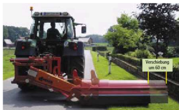
USM 18 mit Verschiebung
