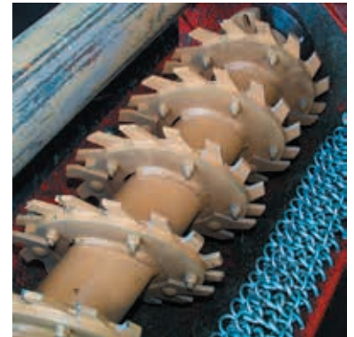
Taumelscheibenwelle des RSM 13
