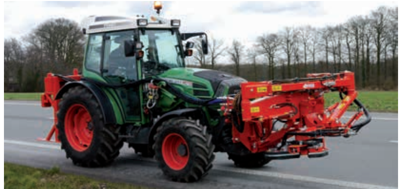
MGK 13 mit Leitpfostenmäher LSM in Transportstellung
