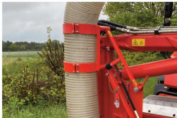
Förderschlauch kann am Ausleger nachgerüstet werden
