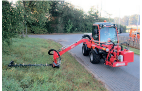
Doppelmessermähwerk DMW im Einsatz am KBM 350
