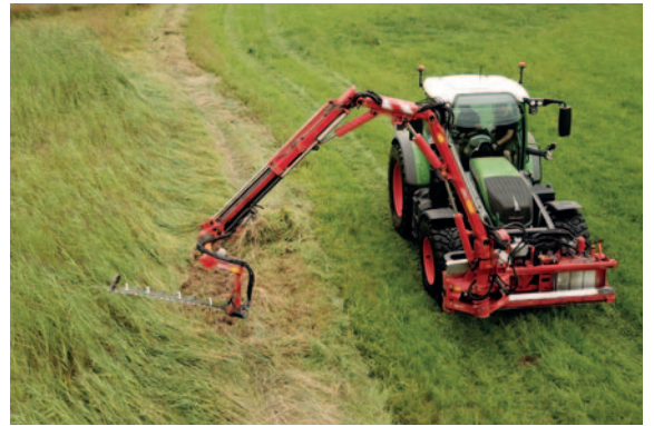
Einsatz des DMW in der Pflege von Böschungen
