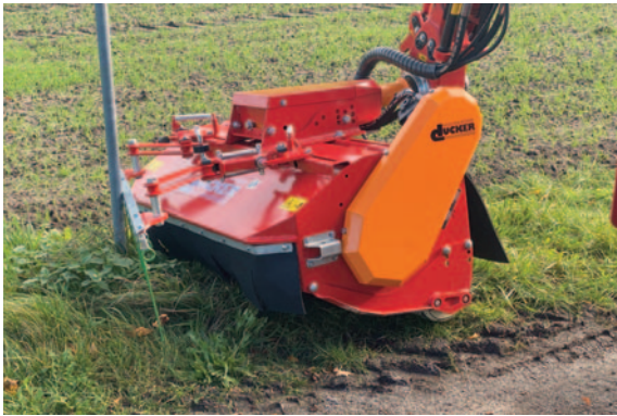
Der ÖKO-Striegel des VMS 1200 ÖKO mit Anfahrtsicherung
