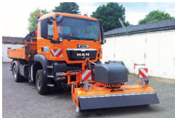
Kehrmaschine FKM, hydraulisch angetrieben am LKW, mit Wassersprüheinrichtung und Wassertank
