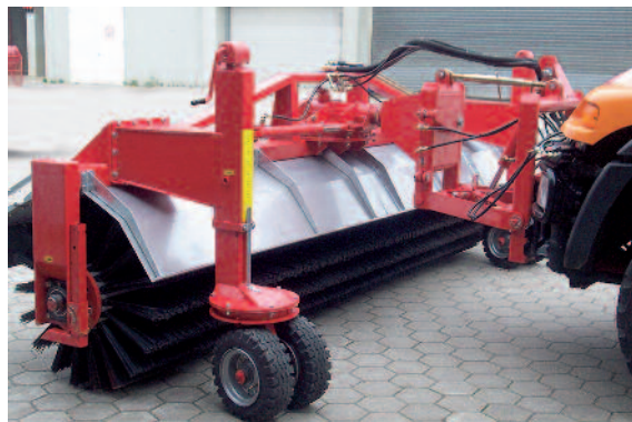
Bodenanpassung über höhenverstellbare Räder
