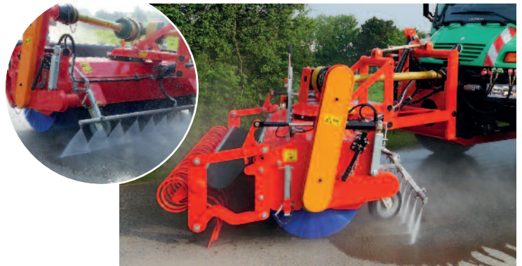
Sonderausführung der SFK 2200 mit Aufkratzeleiste, Wasserhochdruckanlage und Schwemmbalken
