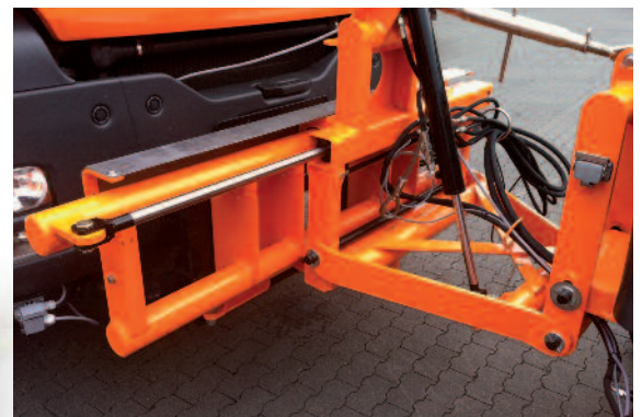
hydraulische Seitenverstellung um 0,60 m
