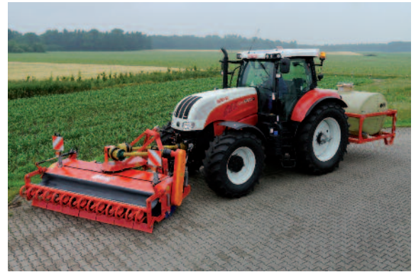
SFK mit Schmutzaufkratzeleiste und Wasserhochdruckanlage in Heckanbau
