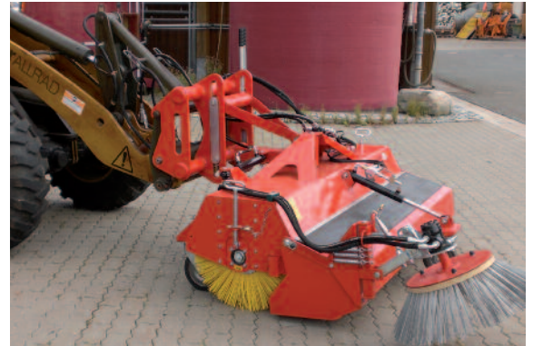
HDK am Radlader mit Höhenausgleich
