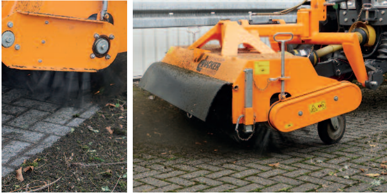
Die Kehrmaschinen HDK 1300, 1600, 1800 sowie FKM 1800 können mit einer Kehrwalze mit Wildkrautbesatz ausgerüstet werden und sorgen so für saubere Pflasterflächen.
