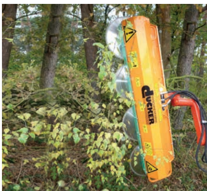
LPS 20 Lichtraumprofilsäge Arbeitsbreite: 2000 mm Sägeblattdrehzahl: 2600 U/min Gewicht: ca. 220 kg Antrieb: 62 ltr. / 180 bar
