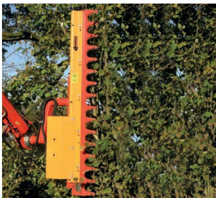
AWS 13 / 22 Ast- und Wallheckenschere Arbeitsbreite: 1300 / 2200 mm Schnittstärke: bis 110 mm Gewicht: ca. 160 kg / 230 kg Antrieb: 40 ltr. / 180 bar
