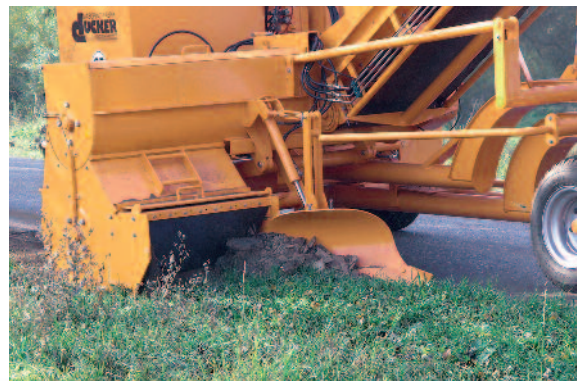
Bankettfräse - Fräsaggregat mit Innenpflug
