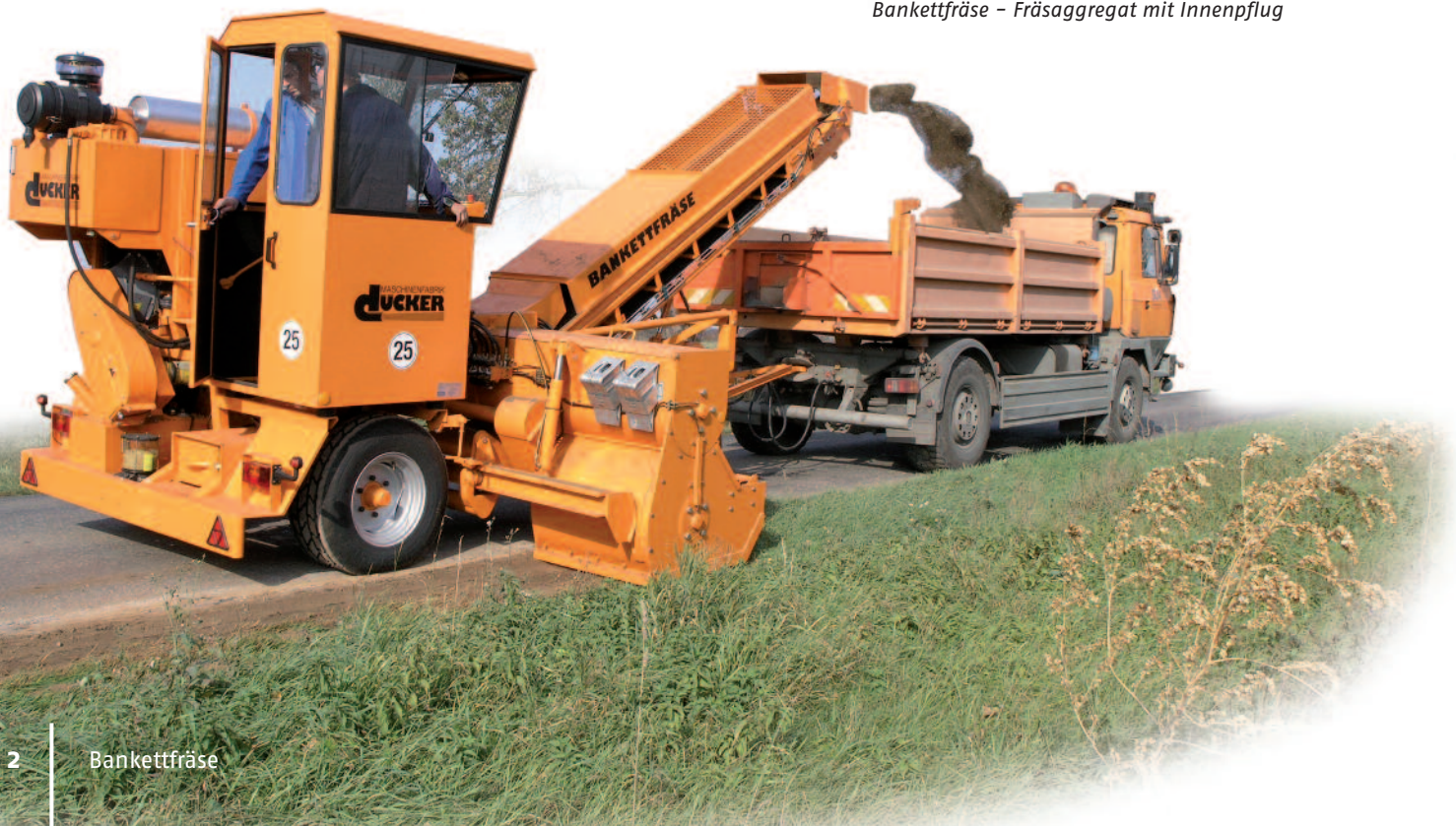
Bankettfräse - Fräsaggregat mit Innenpflug
