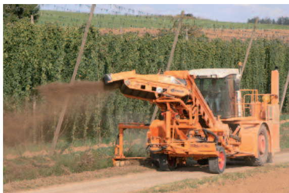
Bankettfräse SBF 900 beim seitlichen Ablegen des Fräsgutes
