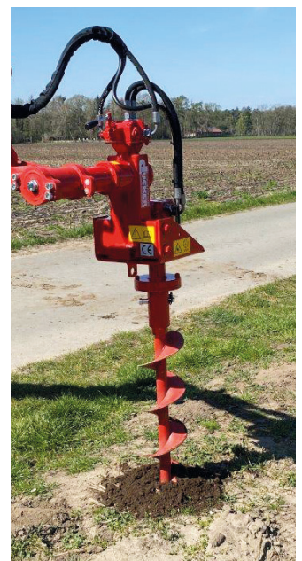
Erdbohrer bestückt mit Bohrspitzen und Schneidzähnen, zum Setzen von Leitpfosten usw. Ø 100 mm, Länge 1200 mm Ø 150 mm, Länge 1200 mm
