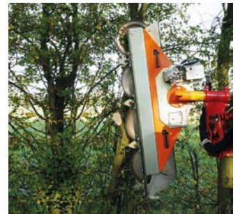
LRS 1602 Lichtraumprofilschneider Arbeitsbreite: 1600 mm Sägeblattdrehzahl: 2600 U/min Gewicht: ca. 150 kg
