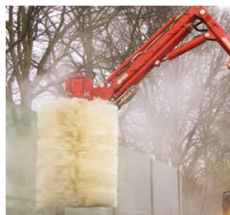
SWA 900 Schilderwaschanlage Bürstenbreite: 900 mm Bürstendrehzahl: 250 U/min Gewicht: ca. 155 kg
