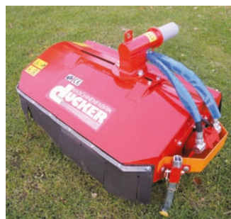
MKL 10 Schlegelmähkopf Arbeitsbreite: 1000 mm Rotordrehzahl: 2700 U/min Gewicht: ca. 180kg
