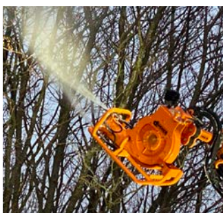
Gebläse mit Sprühvorrichtung Reichweite: bis 25 m Höhe Gewicht: ca. 110 kg
