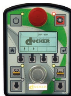
Elektrohydraulische-proportionale CAN-Bus-Steuerung, Multicontroller mit Tastenfeld und Gessmann-Joystick (Wippen-Joystick)
