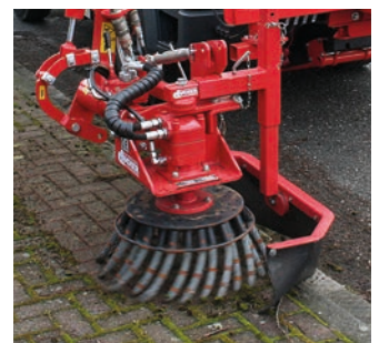
PFP 600 Pflasterputzer Arbeitsbreite: 600 mm Rotordrehzahl: 150 U/min Gewicht: ca. 140 kg
