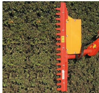
HS 16 Heckenschneider Arbeitsbreite: 1600 mm Schnittstärke: bis 45 mm Gewicht: ca. 120 kg
