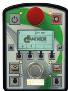
Elektrohydraulische-proportionale CAN-Bus-Steuerung, Multicontroller mit Tastenfeld und Elobau-Joystick (Tasten-Joystick)
