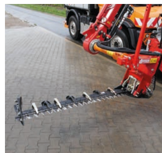
DMW 15 Doppelmesserschneidwerk Arbeitsbreite: 1500 mm Gewicht: ca. 110kg
