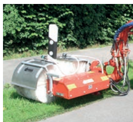
LPW 500 Leitposten und Schilderwaschanlage Arbeitsbreite: 500 mm Drehzahl: max. 375 U/min Gewicht: ca. 150 kg
