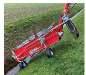
DBR 1800 / 2000 Bandrechen Arbeitsbreite: 1800 / 2000 mm Rotordrehzahl: 450 U/min Gewicht: ca. 230 / 250 kg
