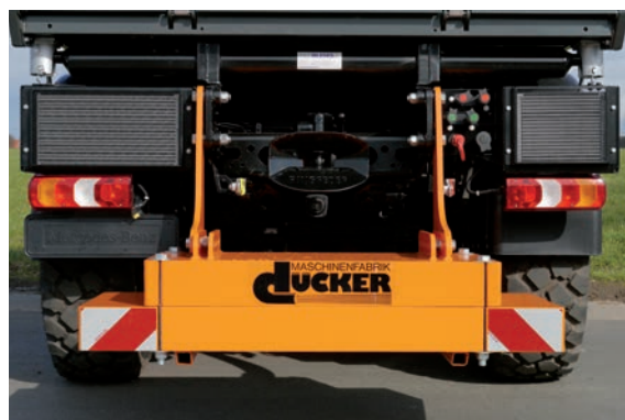
Gegengewicht in den Anbaubeschlagen des Unimog
