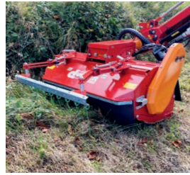
VMS 1200 Öko Schlegelmähkopf Arbeitsbreite: 1220 mm Rotordrehzahl: 2400 U/min Gewicht: ca. 320 kg
