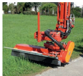
TTM 13 Schlegelmähkopf Arbeitsbreite: 1300 mm Rotordrehzahl: 2800 U/min Gewicht: ca. 270 kg
