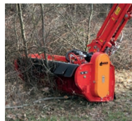
GMK 12 Gestrüppmähkopf Arbeitsbreite: 1200 mm Schnittstärke: bis 60 mm Rotordrehzahl: 2700 U/min Gewicht: ca. 350 kg
