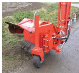
RWB 600 Radialwildkrautbürste Arbeitsbreite: 600 mm Rotordrehzahl: 150 U/min Gewicht: ca. 320 kg
