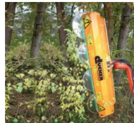
LPS 20 Lichtraumprofilssäge Arbeitsbreite: 2000 mm Sägeblattdrehzahl: 2600 U/min Gewicht: ca. 220 kg
