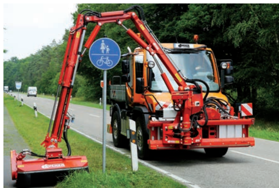
DUA 800 – Der Teleskoparm ermöglicht das Überfahren von Verkehrszeichen.
