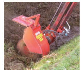
GSF 600 Grabensohlenfräse Fräsdurchmesser: 600 mm Rotordrehzahl: 800 U/min Gewicht: ca. 230 kg
