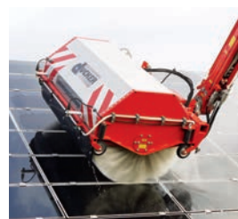
TWA 18 Tunnelwaschanlage Bürstenbreite: 1800 mm Bürstendrehzahl: 280 U/min Gewicht: ca. 285 kg
