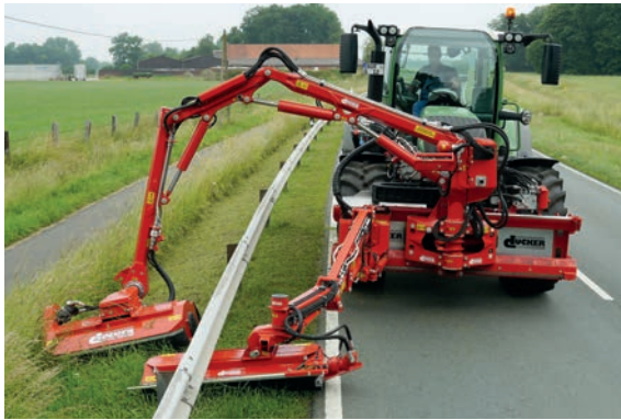
Mähkombination MK bestehend aus DUA 700 und RSM am Fendt-Schlepper beim gleichzeitigen Mähen hinter und unter Leiteinrichtungen
