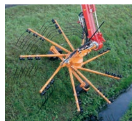
DKH 2000 Kreiselharke Arbeitsbreite: 2000 mm Rotordrehzahl: 170 U/min Gewicht: ca. 250 kg
