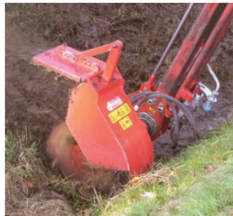
GSF 600 Grabensohlenfräse Fräsdurchmesser: 600 mm Rotordrehzahl: 800 U/min Gewicht: ca. 230 kg
