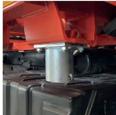
Der Aufbau auf den Pritschenzwischenrahmen mit werkzeugloser Verriegelung ermöglicht eine einfache Montage
