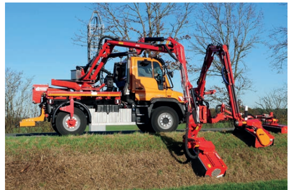
Die Mähkombination mit drei Mähköpfen ermöglicht die Mahd von 3 Schnitten in einem Arbeitsgang
