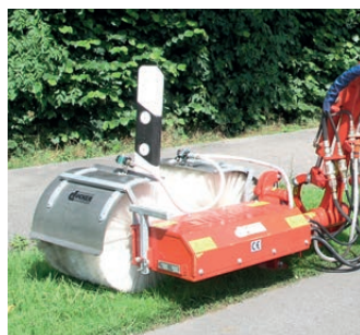
LPW 500 Leitpfosten und Schilderwaschanlage Arbeitsbreite: 500 mm Drehzahl: max. 375 U/min Gewicht: ca. 50 kg
