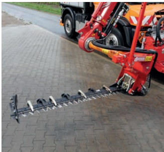
DMW 15 Doppelmesserschneidwerk Arbeitsbreite: 1500 mm Gewicht: ca. 110 kg
