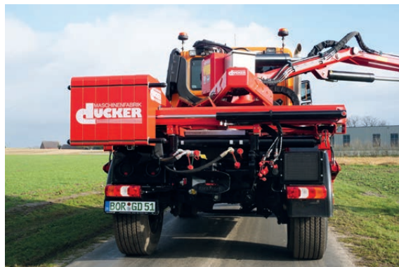
Das hydraulisch verschiebbare Gegengewicht
