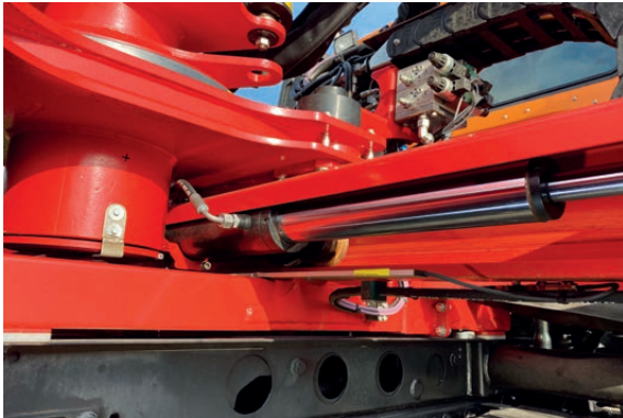
Verschiebung des Läufers über Hydraulikzylinder
