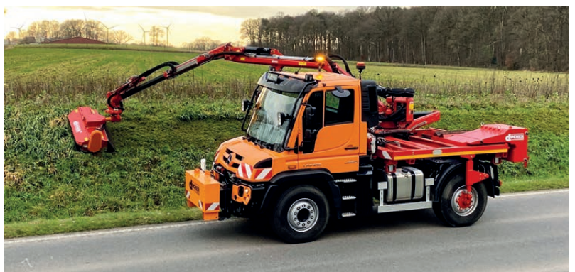
Beim Vor- und Rückschwenken des Auslegers wird das Arbeitsgerät automatisch parallel zum Fahrzeug geführt
