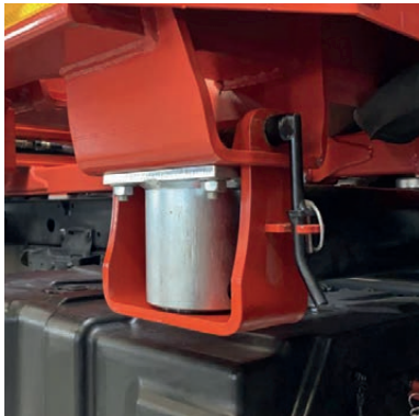
Der Aufbau auf den Pritschenzwischenrahmen mit werkzeugloser Verriegelung ermöglicht eine einfache Montage
