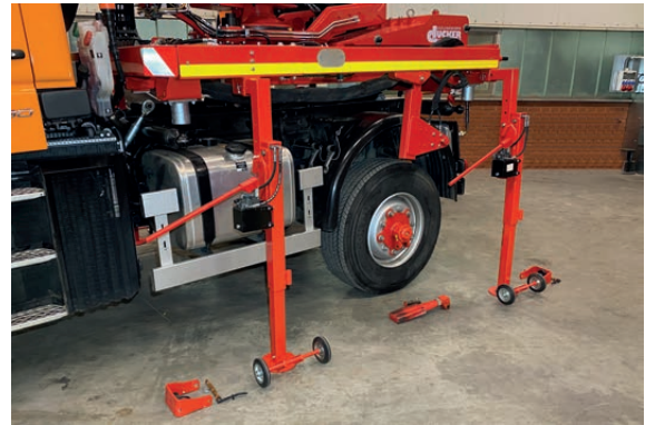
Auf Rollen fahrbare hydraulische Abstellstützen
