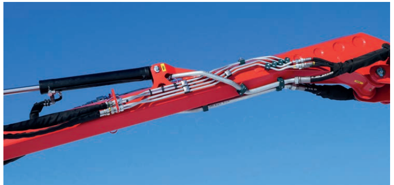
Fest verlegte Hydraulikleitungen aus Stahl
