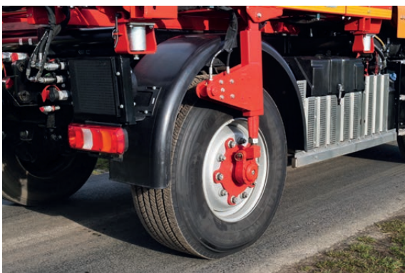
Achsabstützung des Grundrahmens
