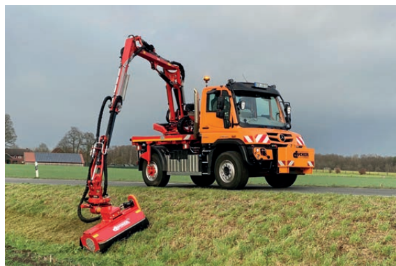
Der DAM 1050 beim Mähen einer Böschung
