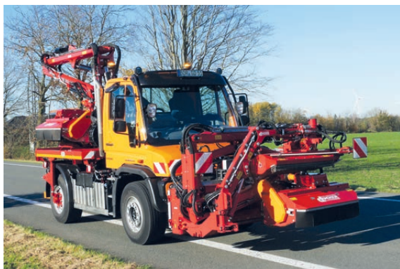
DAM als Mähkombination in Transportstellung
