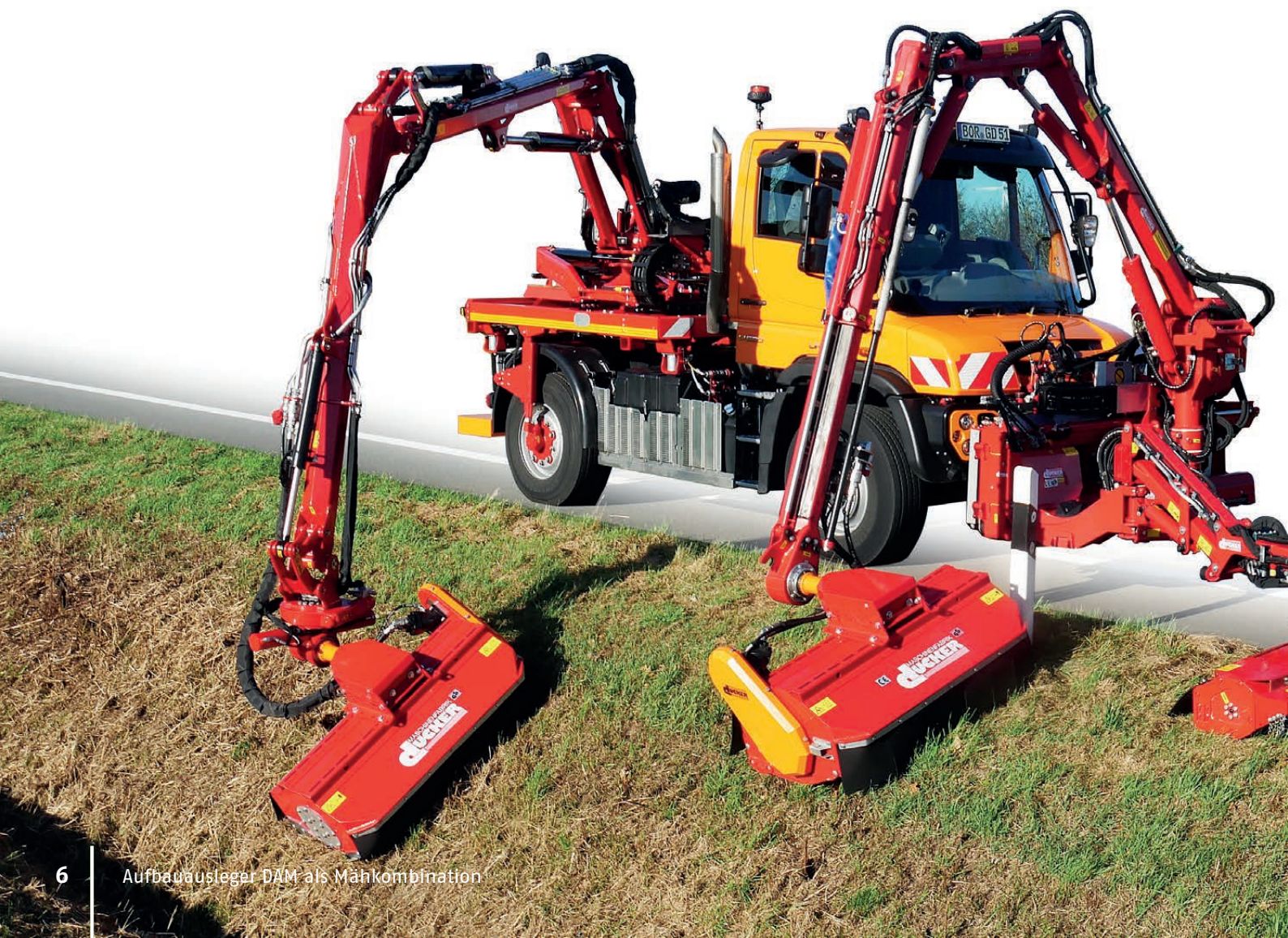
Die Mähkombination mit drei Mähköpfen ermöglicht die Mahd von 3 Schnitten in einem Arbeitsgang
