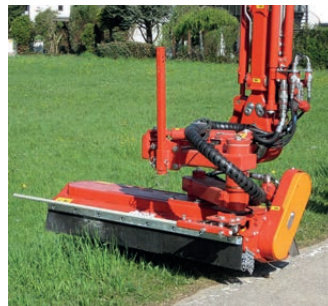
TTM 13 Schlegelmähkopf Arbeitsbreite: 1300 mm Rotordrehzahl: 2800 U/min Gewicht: ca. 270 kg
