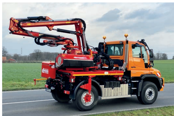
Transportstellung des Aufbauauslegers DAM
