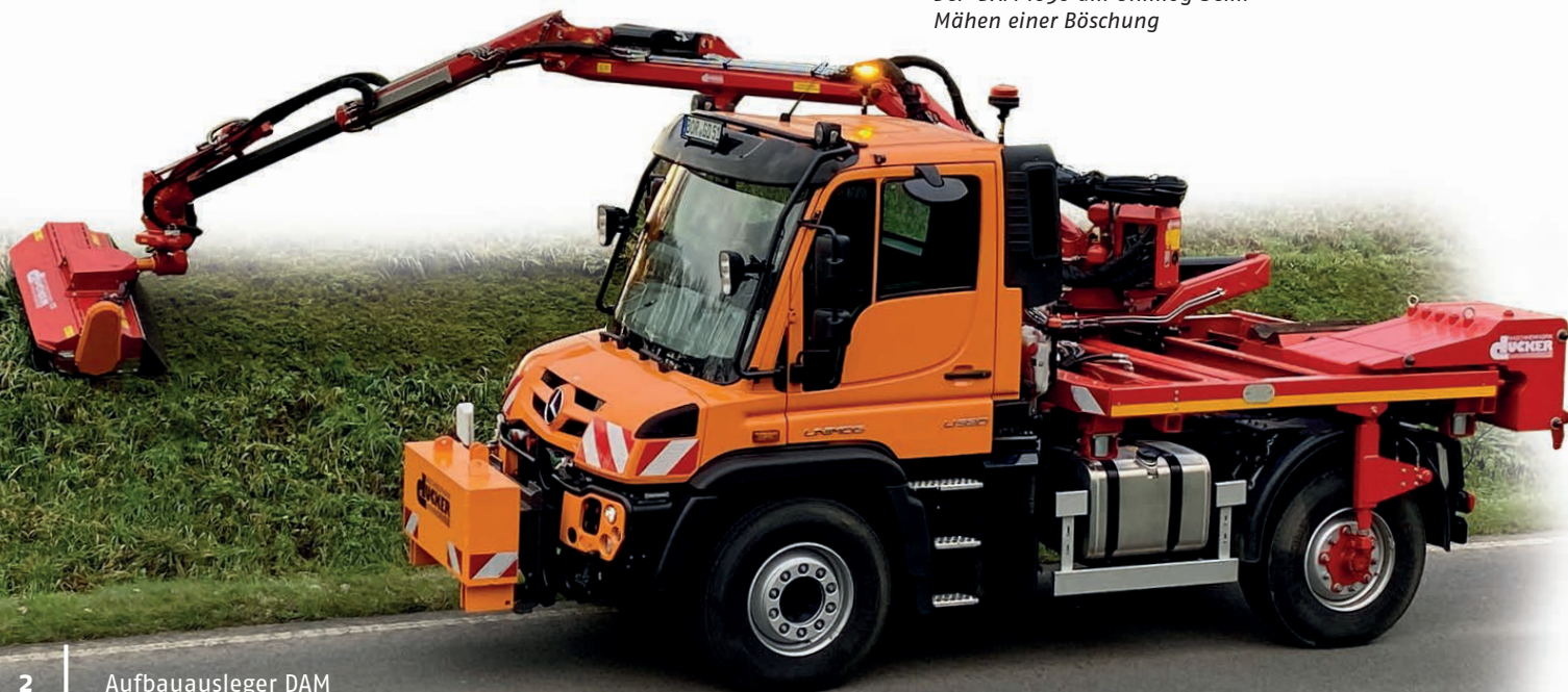
Der DAM 1050 am Unimog beim Mähen einer Böschung
